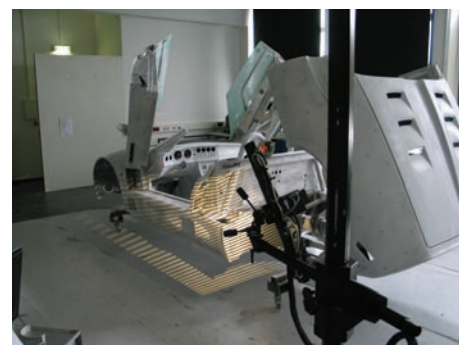
Mobile ATOS-Messung des Body in White
