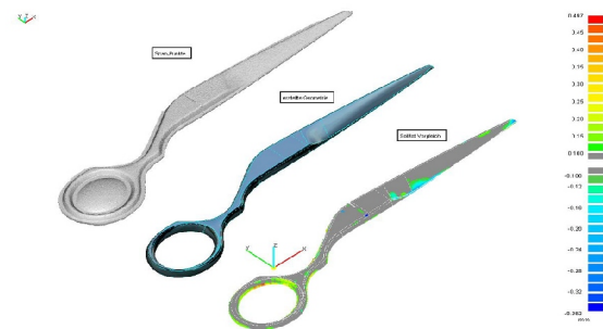
Scan-Punkte, erstellte Geometrie, Soll-Ist Vergleich
